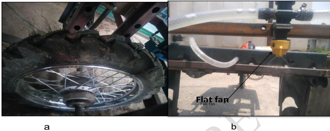
Fig. 4 (a)-Tire and (b)-Flat fan nozzle
